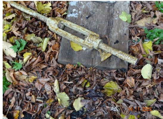
Schloss der alten, ausgebauten Sicherung
